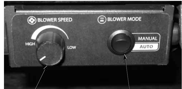
Blower Speed Control Knob (rheostat)
