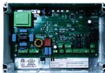
ADC150 Fan Control
