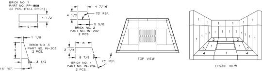
FIGURE 6: INGLENOOK FIREBRICK SYSTEM
