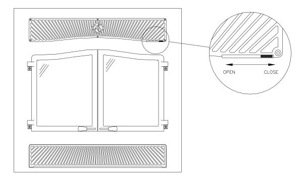
FIGURE 1: COMBUSTION AIR DAMPER CONTROL
