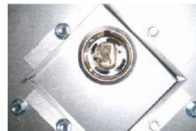
**Lors du réassemblage de la lumière, faites attention. Il est possible que des « fuites de lumière » soient visibles au dessus des portes en fonte. Les trous dans le boîtier de la lumière sont nécessaires à la ventilation et ne doivent pas être couverts.**
